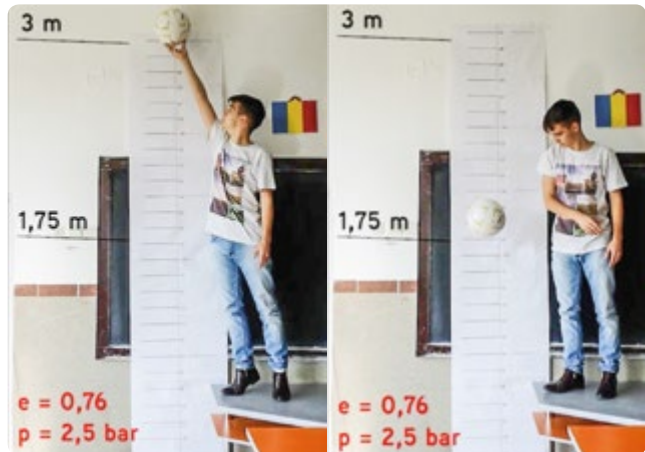
FIG. 5 Håll bollen på en höjd av h_1 (vänster), släpp bollen (höger)
