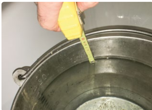
FIG. 2 Mät nivån för att bestämma vattenvolymen
